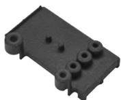
L'adattatore per morsettiere studiato appositamente per la TH212 è installabile grazie al solo utilizzo di una vite M4 autofilettante - 0,5 Nm. È stato realizzato per accogliere morsettiere Techno, ma anche per utilizzare morsetti di terze parti. L'utilizzo dell'accessorio rende possibile l'installazione del laccetto di fissaggio del coperchio, ma compromette l'utilizzo delle due uscite M16 presenti sulla base della scatola.
