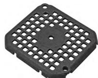
Techno ha realizzato una gamma di accessori dedicati al coperchio della TH212. L'assemblaggio avviene con due viti M4 a 0,5 Nm di coppia. Progettato per ospitare morsettiere di Techno e di altri fornitori, offre una soluzione adattabile a una vasta gamma di driver. L'utilizzo dell'accessorio rende possibile l'installazione del laccetto di fissaggio del coperchio, ma compromette l'utilizzo dell'eventuale uscita M20 su coperchio.
