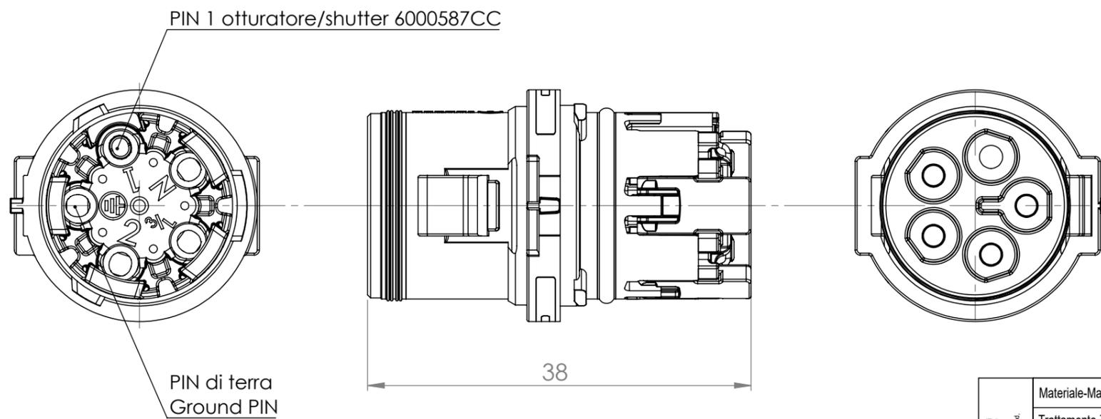
Tolleranze generali Particolari stampati in materiale termoplastico: rif ISO 2768MK - Particolari lavorati alle macchine utensili: rif. UNI EN 22768
