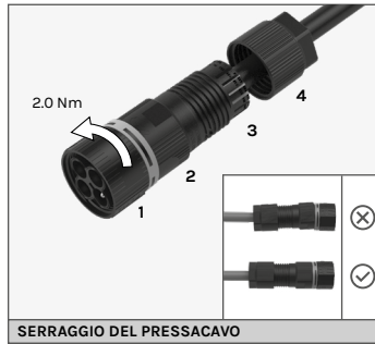
SERRAGGIO DEL PRESSACAVO
