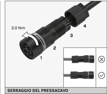
SERRAGGIO DEL PRESSACAVO
